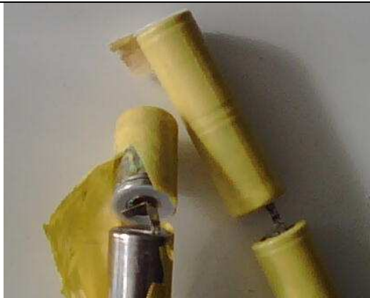
Alter Akku-Pack zerlegt
